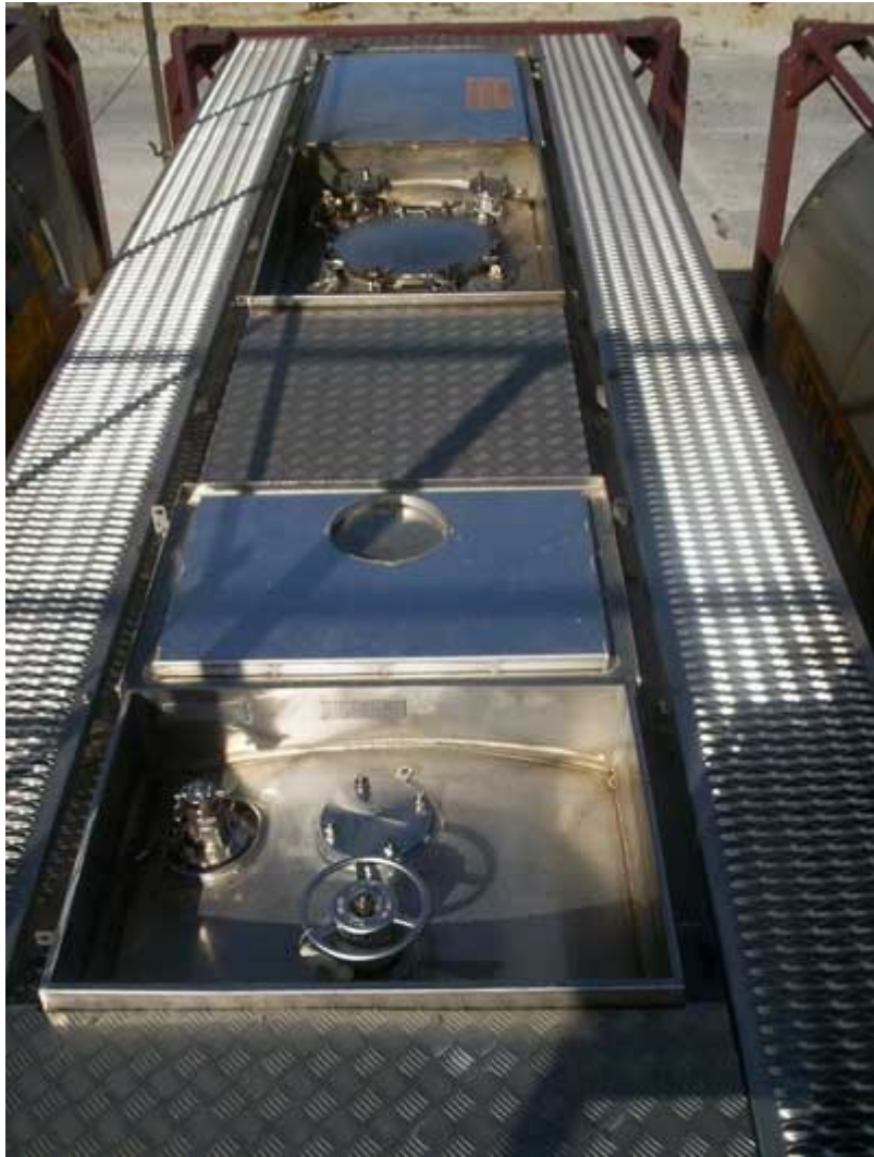
Fot. 3 - Widok z góry na kontener typu VanHool - na pierwszym planie przyłącze do ciśnienia roboczego (powietrze lub azot), plan drugi to wąż kontrolny i zawór wpustowy
